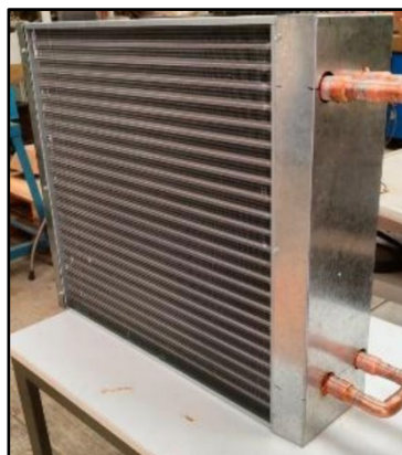
Figura 43. Filtro del intercambiador de calor.
